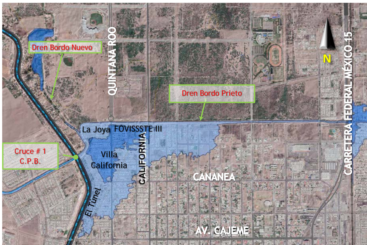
Imagen 5.1.3.7: Mancha de inundación que se genera al llegar al cruce #2 del C.P.B.
