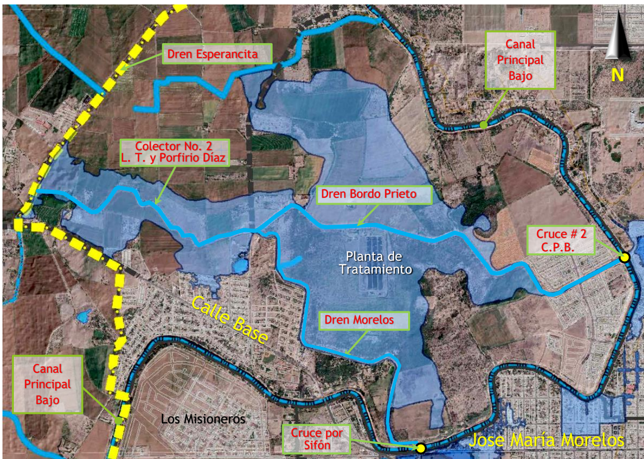
Imagen 5.2.3.1: Área inundable en esta zona, marcada por estudios realizados antes de la rectificación del Dren Bordo Prieto.
