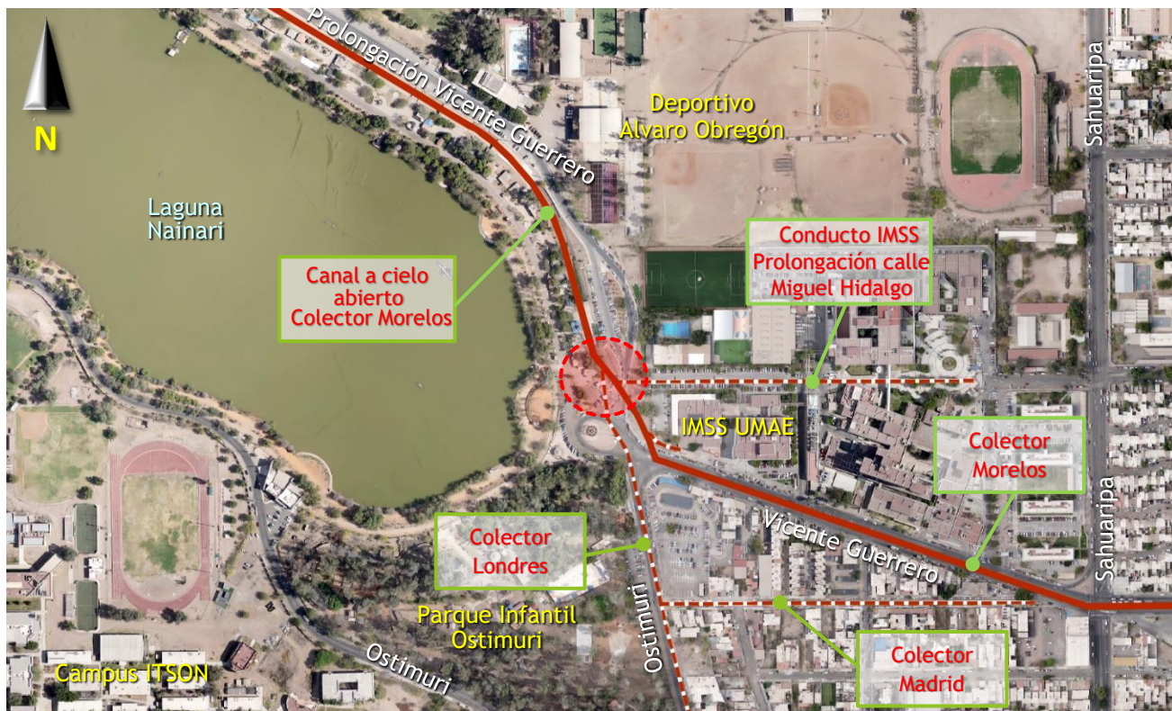
Imagen 5.3.2.1: Punto de unión de los múltiples colectores y subcolectores existentes en la zona centro.
